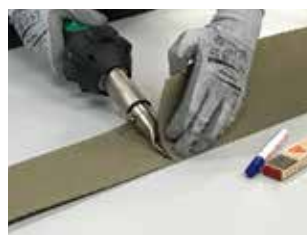
Heißluftgebläse Leister Triac AT für die Stoß- verbindung mittels homogener Überlapp- schweißung
