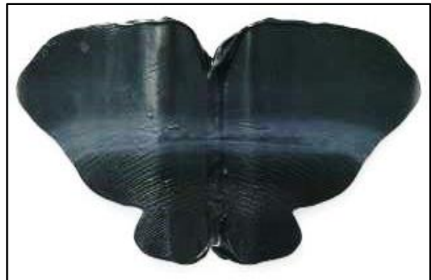
BILD 12 Folie auffalten - Negativer Test = unzureichende Mischung
