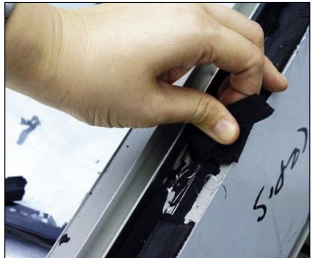
BILD 20 Klebstoffversagen, Entglasungstest nicht in Ordnung
