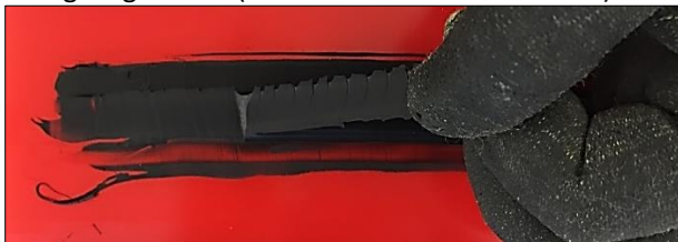
BILD 17 Raupenschältest: Abzug der Raupe, 100% kohäsives Versagen
