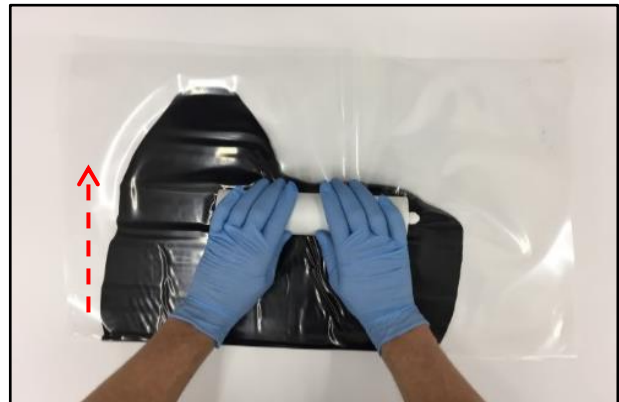
BILD 10 Die Klebstoffraupe nur rechtwinklig zum Falz beaufschlagen
