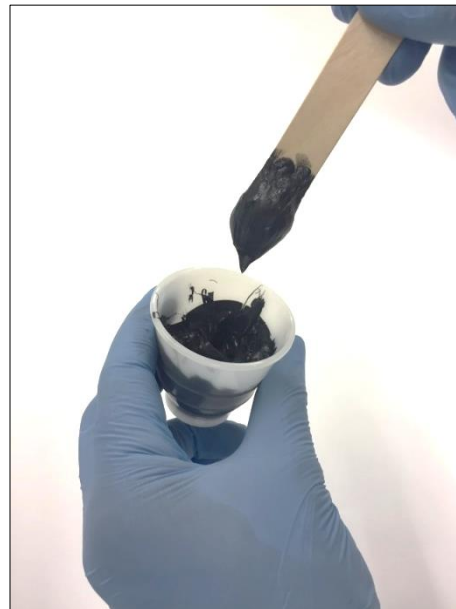
BILD 15 Material zeigt gummiähnliche Eigenschaften: → Topfzeit erreicht
