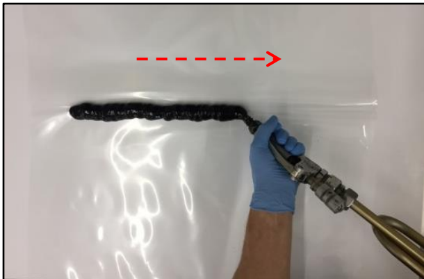
BILD 9 Klebstoffraupe in Richtung des Falzes auftragen
