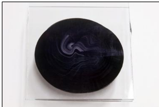
BILD 8 Negativer Test = unzureichende Mischung
