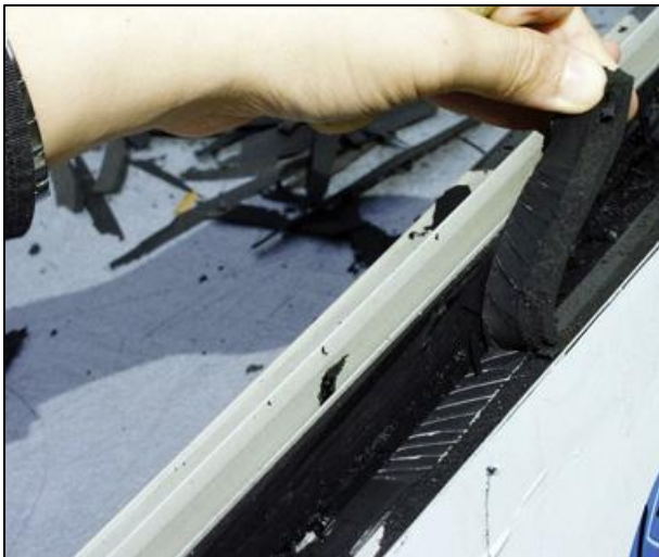
BILD 19 Gute Haftung (Adhäsion), Entglasungstest erfolgreich
