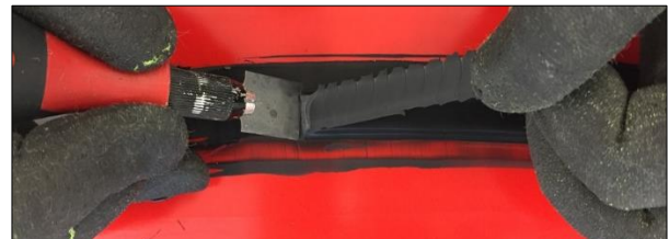
BILD 18 Raupenschältest auf emailiertem Glas: Einschneiden der Raupe während diese abgezogen wird
