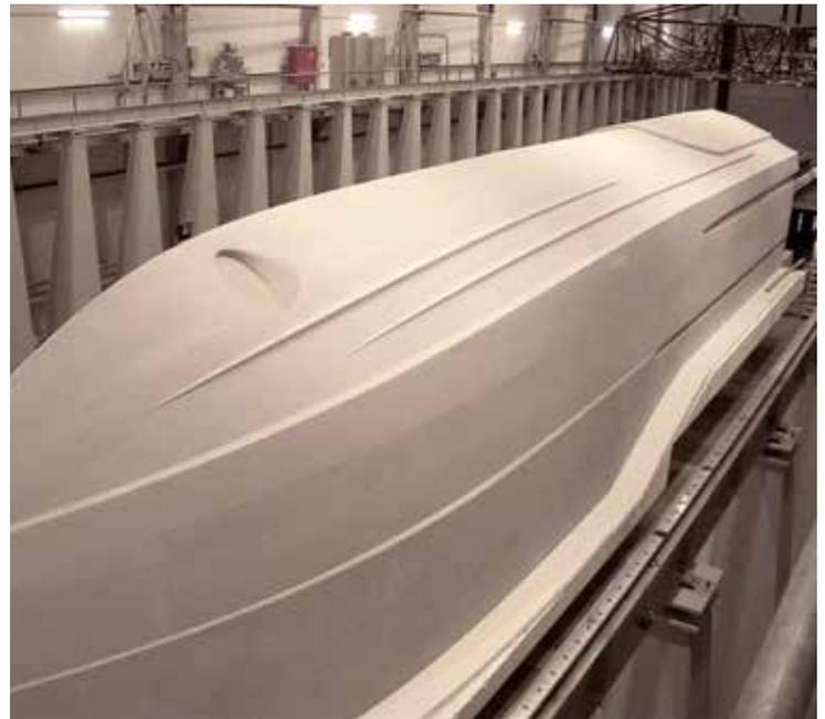
43 Meter langer Bootsrumpf mit einer perfekt gleichmäßigen und fugenfreien Oberfläche hergestellt mit SikaBiresin® SC175
