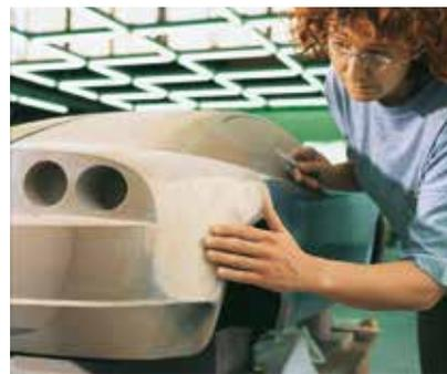
Hochwertiges Urmodell aus SikaBlock® M600 N / 700 N mit bester Dimensionsstabilität
