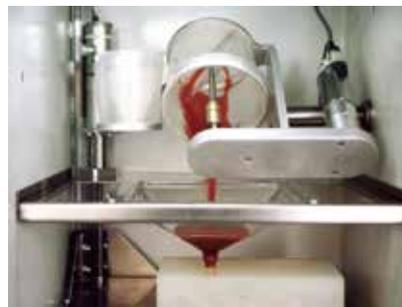
Das Vakuumgießverfahren ermöglicht die Herstellung von Teilen mit einem ausgezeichneten optischen Aspekt sowie besten mechanischen Eigenschaften
