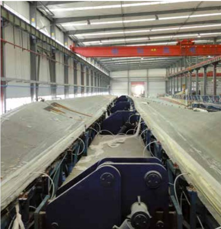
Vakuuminfusion eines Rotorblattes mit SikaBiresin® CR131
