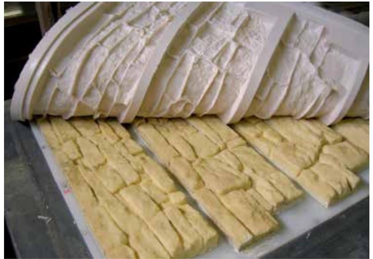
Entformung einer flexiblen Form für eine Verkleidung in Steinoptik hergestellt mit SikaBiresin® UR548
