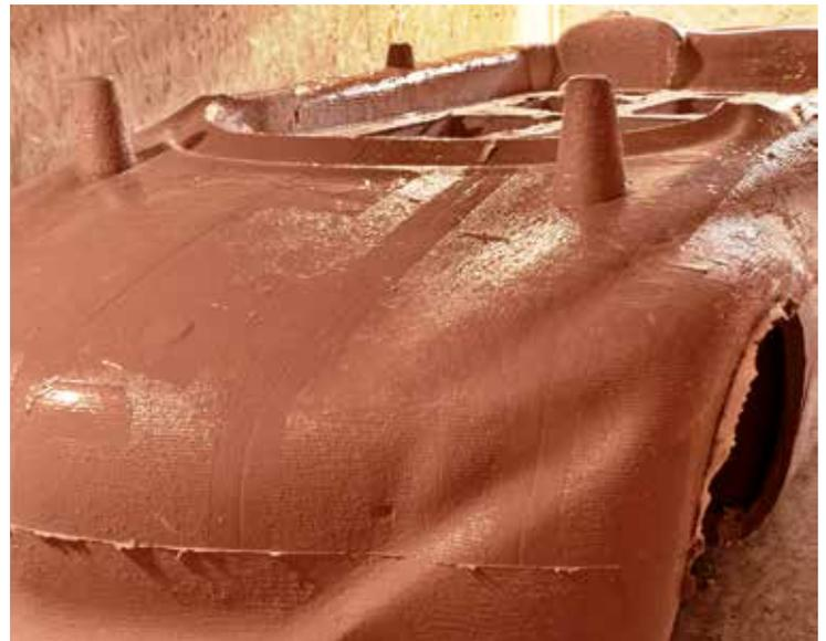
Große Modelle im Maßstab 1:1 können mit SikaBiresin® M67 in einem Schritt vergossen werden
