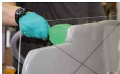
Die thixotrope Einstellung von SikaBiresin® SC175 ermöglicht selbst einen vertikalen Auftrag von einzelnen Raupen ohne Absacken
