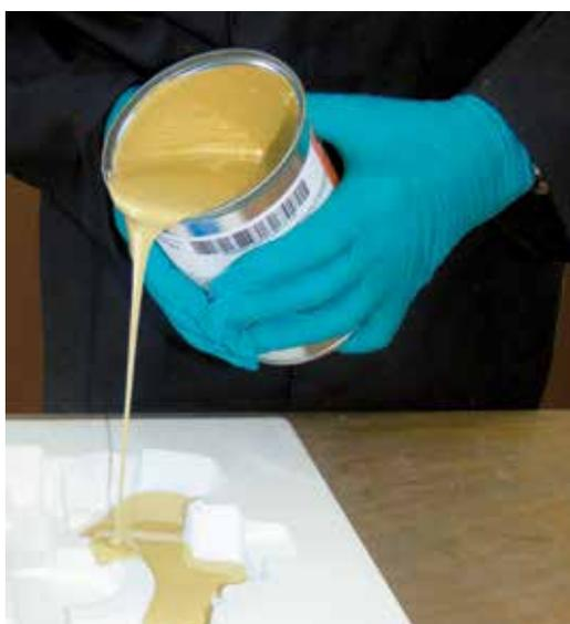
SikaBiresin® F160 mit Füllstoffzugabe für den Verguss von Modellen mit höherer Schichtstärke
