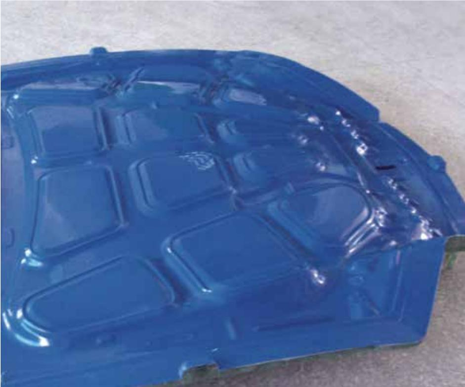
Werkzeug aus SikaBiresin® GC080 zur Herstellung von Verstärkungen für Motorhauben
