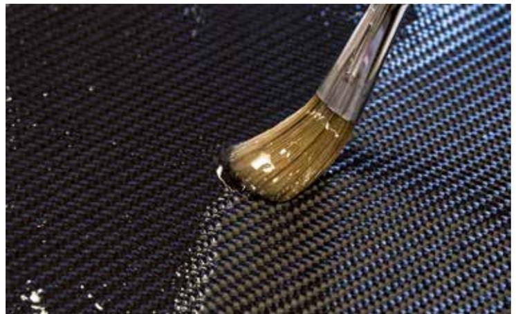
SikaBiresin® CR82 mit optimierter Viskosität für den Wet Lay-Up Prozess
