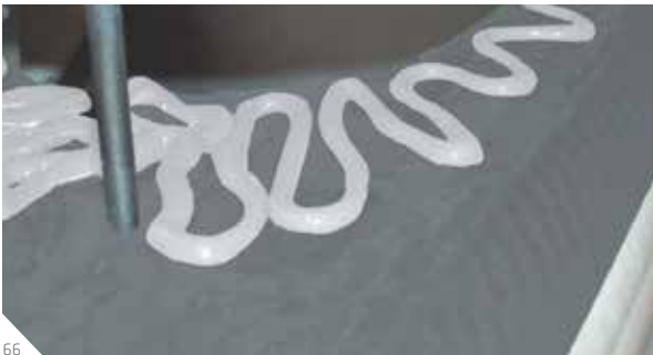
Abb. 66: Ein Fixierstift hilft zur genauen Ausrichtung der Kleberaube.
