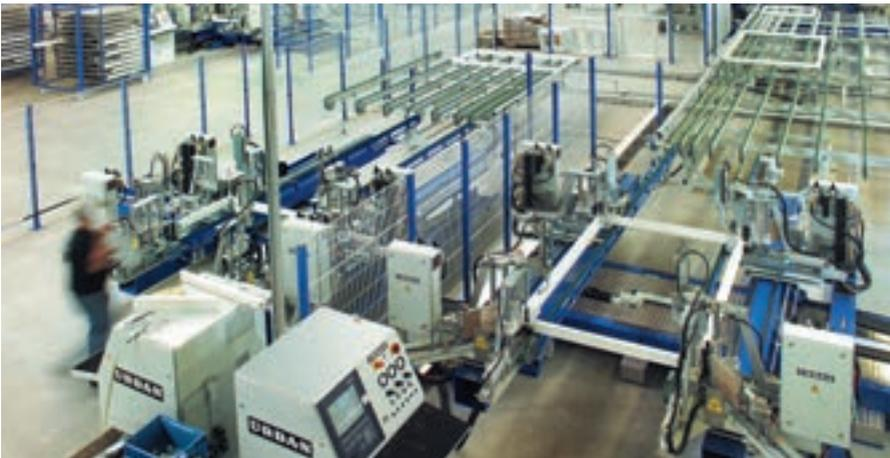
450 Fenstereinheiten werden auf dieser Anlage in einer Schicht gefertigt. Die besondere Herausforderung für unsere Klebstoffe lag in der sehr kurzen Taktzeit von nur 45 Sekunden. Um ein leichtes Fügen bei hoher Standfestigkeit zu ermöglichen, muss der Klebstoff immer die richtige Viskosität aufweisen. Und nur ein paar Minuten später – beim Putzen und Schrauben – sind eine hohe Tragkraft und Widerstandskraft gefordert.
