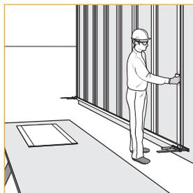
Entfernen Sie Staub mit einem fusselfreien Zellstofftuch oder Reinigungspapier.
