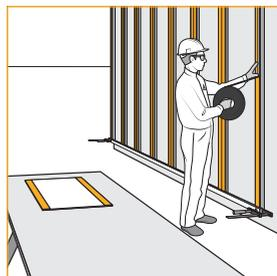
SikaTack® Panel Montageband über die gesamte Länge der senkrechten Profile und parallel zu den Kanten auftragen. Die Schutzfolie noch nicht abziehen.
