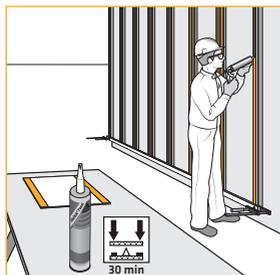
Tragen Sie den SikaTack® Panel Klebstoff als Dreiecksraupe mit der mitgelieferten Dreiecksdüse (Breite 8 mm, Höhe 10 mm) in einem Mindestabstand von 5 mm vom Montageband zur seitlichen Kante des Profils auf.
