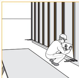
Setzen Sie die Fassadenpaneele zuerst an der vorgesehenen Stelle an, ohne dass sie das Montageband berührt. Drücken Sie dann fest bis zum Kontakt mit dem SikaTack® Panel Montageband an.
