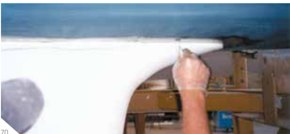
Abb. 70: Die Verbindungsfuge wird fertiggestellt
