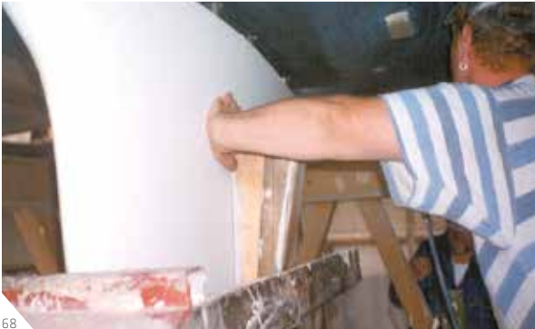
Abb. 68: Den Kiel vorsichtig in die gewünschte Position schieben
