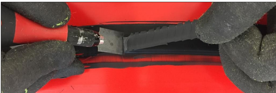
Bild 12: Raupenschältest auf emailliertem Glas: Einschneiden der Klebstoffraupe während diese abgezogen wird
