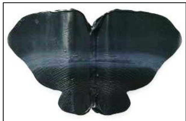
Bild 18: Folie auffalten: Negatives Ergebnis = unzureichende Mischung
