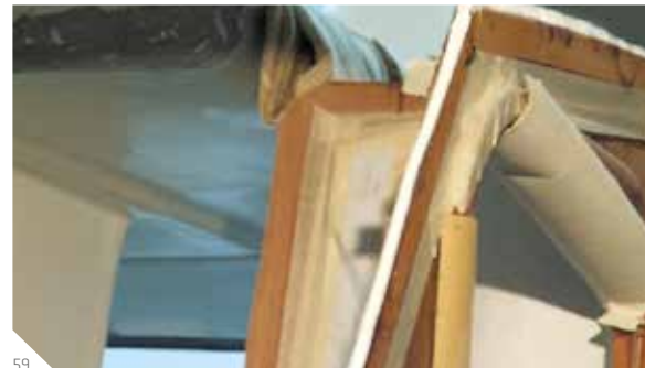
59 Abb. 59: Sikaflex®-292i auf einer Leichtbauplatte vor der Verklebung
