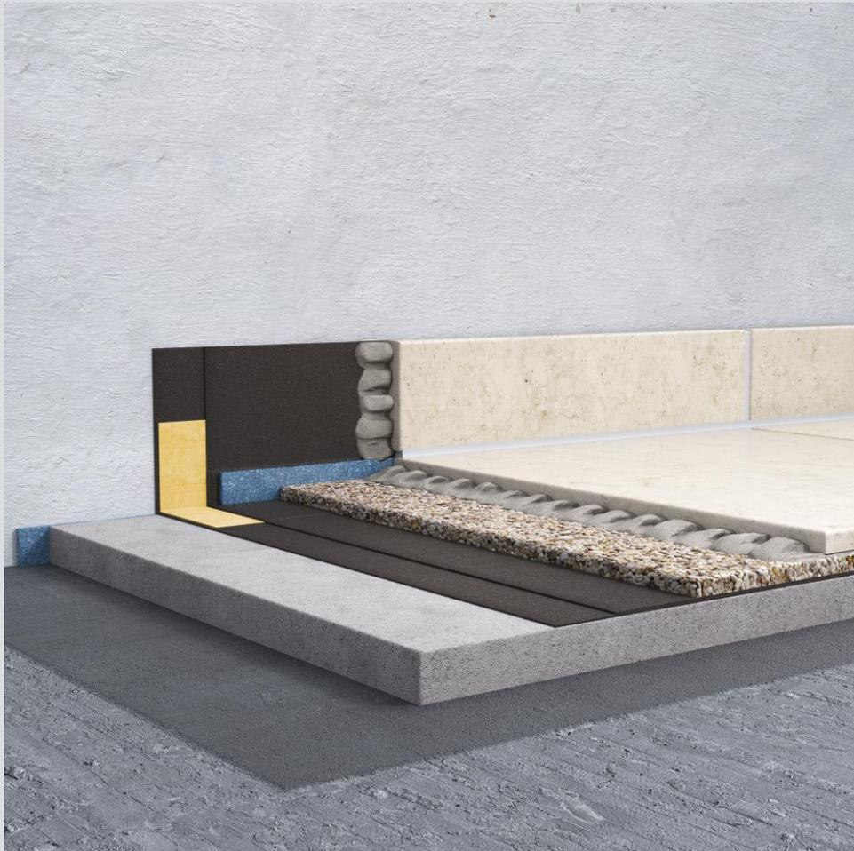
Die Vorteile bei diesem System liegen darin begründet, dass bei der Dünnschichtdrainage eine geringere Aufbauhöhe  $\geq 8$  mm realisierbar im Rahmen des BALTERRA®-Systems ist. Parallel sind keine Komponenten beinhaltet, die zu Ausblühungen führen.
