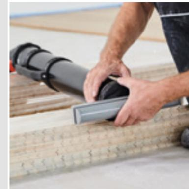
Den Düsenkopf ganz einfach ohne Werkzeug festschrauben.
