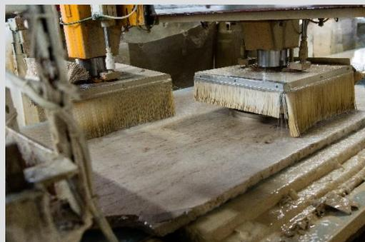
Die Rohplatten, auch Unmaßplatten genannt, werden mehrmals geschliffen. Je nach Stein werden unterschiedliche Schleifkörnungen eingesetzt. Es wird sich von grober Körnung bis zur feinen Körnung bzw. Politur hoch geschliffen. Bei einer Oberfläche mit 120er Schliff können noch Schleifspuren sichtbar sein. Der 220er Schliff hinterlässt eine glatte Oberfläche, vergleichbar mit einer Politur, nur ohne Glanz.
