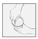
6. Sikalastic® Primer Uni EPOXY SF im Gefäß gründlich und gleichmässig mit einem Rührholz min. zwei Minuten rühren, bis eine homogene, weiße Mischung entsteht. Der Boden und Rand des Behälters muss ebenfalls miterfasst sein.
