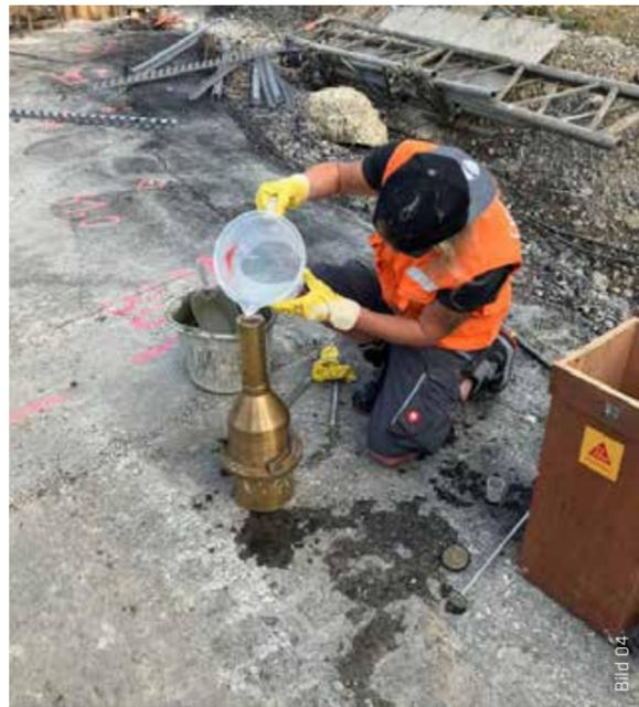
Vor Ort wurden die Mikroholzkugeln im Beton mittels Roll-A-Meter nachgewiesen.
