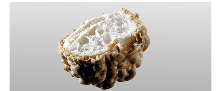
Palusol®, nachdem es Feuer ausgesetzt wurde: Druckfester und hitzebeständiger Palusol®-Festkörper
