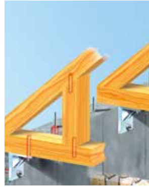
NACHTRÄGLICHER EINBAU VON ANKERN
