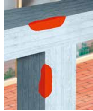
INSTANDSETZUNG VON STATISCH RELEVANTEN BETONAUSBRÜCHEN
