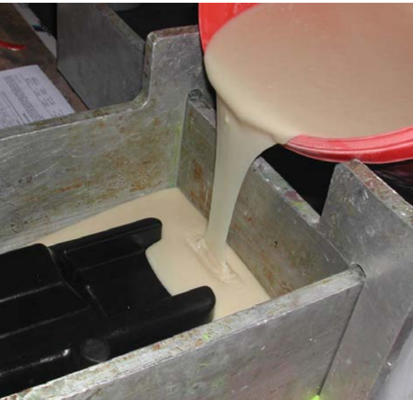
Das gebrauchsfertige SikaBiresin® F46 und die beiden füllbaren Systeme F48 und F50 sind langsame Systeme, die sich für das manuelle Gießen von großformatigen Negativen, Modellen oder Formen mit minimalem Schwund eignen.
