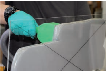
Die thixotrope Einstellung von SikaBiresin® SC175 ermöglicht den vertikalen Auftrag von einzelnen Raupen ohne Ablaufen
