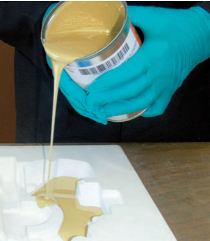
SikaBiresin® F160 mit Füllstoffzugabe für den Verguss von Modellen mit höherer Schichtstärke
