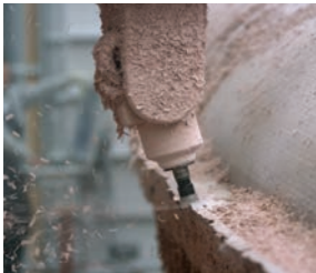
SikaBiresin® M72 lässt sich leicht und staubarm fräsen
