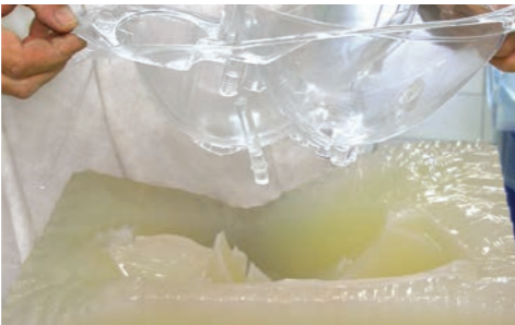
Entformen eines optischen Bauteils aus SikaBiresin® PX521 / PX522
