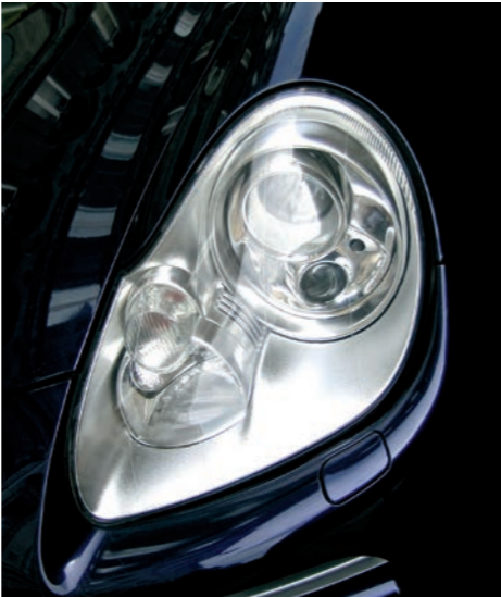
Scheinwerferglas aus SikaBiresin® PX521 / PX522
