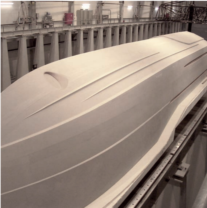
43 Meter langer Bootsrumpf aus SikaBiresin® SC175 mit einer vollkommen glatten und fugenfreien Oberfläche
