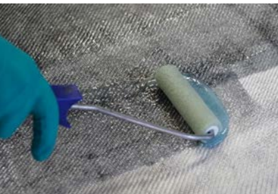
Handlaminierverfahren mit SikaBiresin® CR168
