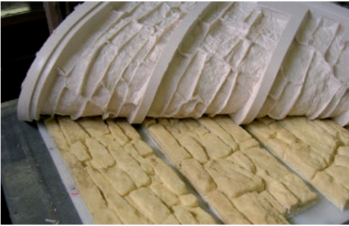
Entformen der weichen Form für Steinverkleidungen aus SikaBiresin® UR548
