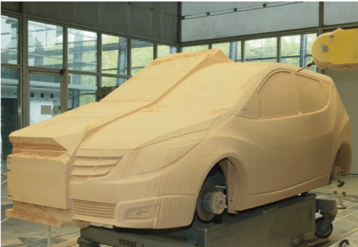
Designmodell im Maßstab 1:1 aus SikaBlock® M330, verklebt mit SikaBiresin® B260
