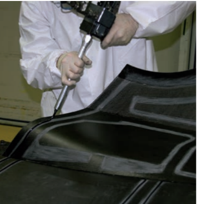
Von links nach rechts ■ Sikaforce®-453 L04 – struktureller 2K-PUR-Klebstoff mit hoher Schälfestigkeit und Bruchdehnung. ■ Verklebung von Kohlefaser-Bauteilen. ■ Verklebung mit SikaPower®-752 L120 FR auf der Decklage eines Wabenkerns (Nomex oder AluMinium).
