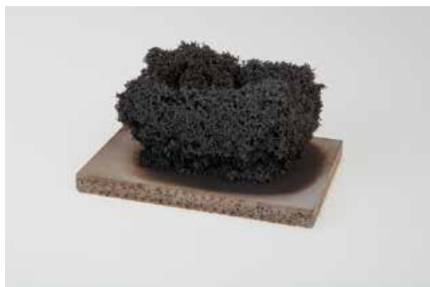
Hoch intumeszierendes, brandbeständiges Dichtungsband vor (oben) und nach (unten) dem Einfluß von großer Hitze.
