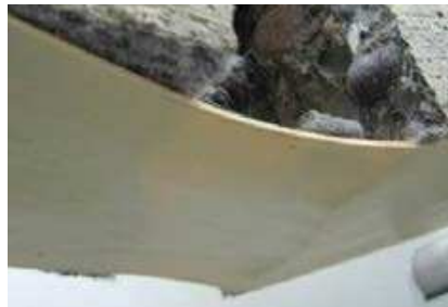
Dehnfähigkeit und Rissüberbrückung am Beispiel eines Biegezugversuches
