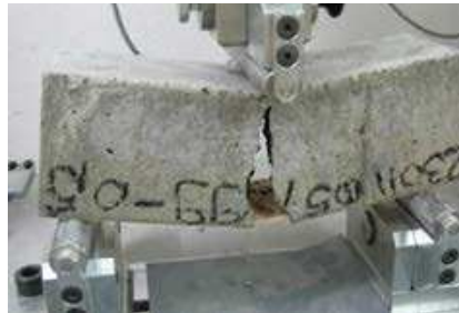
Dehnfähigkeit und Rissüberbrückung am Beispiel eines Biegezugversuches
