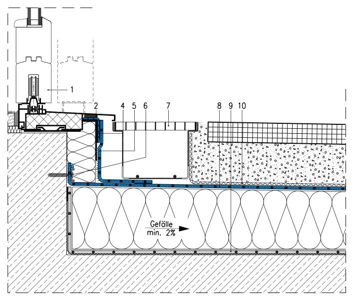
Ohne Massstab Die Dachabdichtung ist überhöht dargestellt
