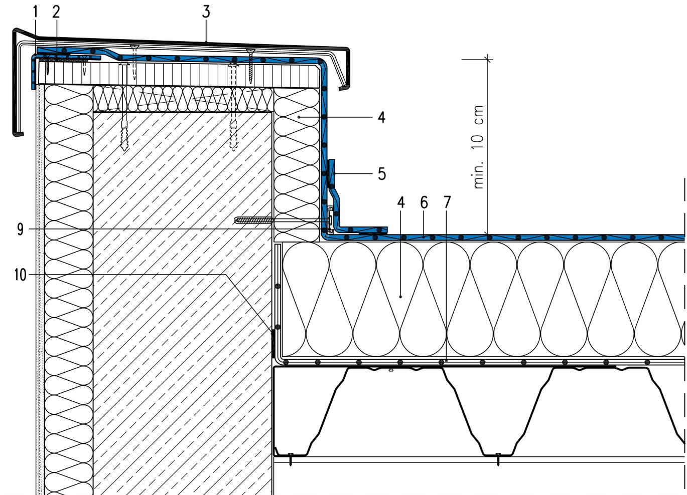
Ohne Massstab Die Dachabdichtung ist überhöht dargestellt
