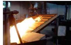
3. Brandversuch von der Oberseite des Daches (External fire testing)
