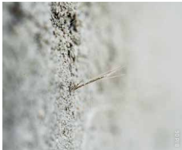
Die PCC-Faserarmierung im Grobmörtel Sika MonoTop®-603 NEU erhöht seine Zug- und Druckfestigkeit.
