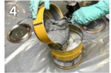
Komponente B zu Komponente A zugeben.
