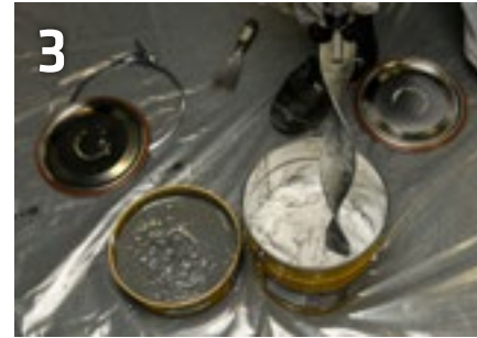
Geeignetes Mischpaddel zum Anrühren von Epoxidharzkleber verwenden.
