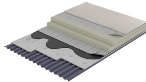
Die Verlegung des Cover Boards als Trägerplatte direkt auf den Trapezprofilen und in Kombination mit der Dampfsperre schafft eine sofortige temporäre Abdichtung und sichert den Baufortschritt. Zudem erhöht das Gewicht der Trägerplatte den Schallschutz und reduziert die Brandlast des Flachdachs.
