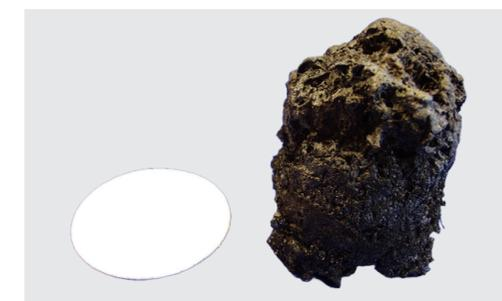
Aufschäumkörper von Interdens® Type 15: Ab einer Temperatur von ca. 150°C beginnt sich Interdens® Type 15 auf ein Vielfaches seines ursprünglichen Volumens aufzublähen
