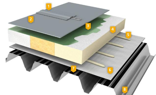
\*Zusätzliche mechanische Befestigung der Bahn möglich, z. B. durch Sarnabar® Befestigungsprofile im Eckbereich
