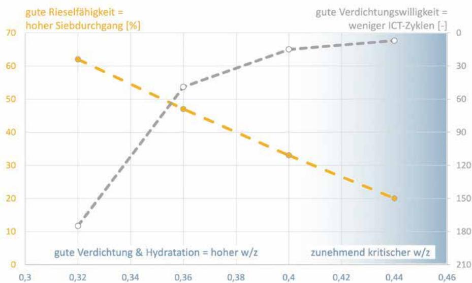
Abb. 5: Einfluss des w/z-Werts auf Rieselfähigkeit und Labor-Verdichtungswilligkeit
