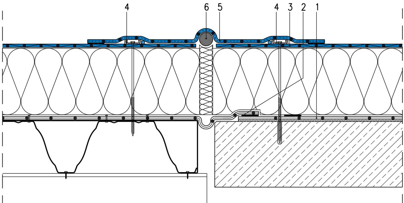
Ohne Masstab Die Dachabdichtung ist überhöht dargestellt
