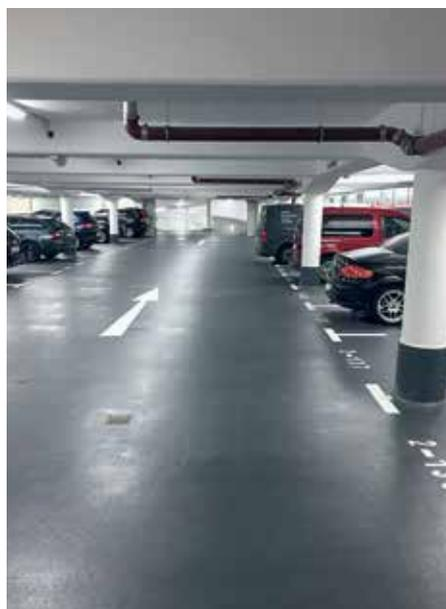
Abb. 1: WU-Wanne (Beispiel einer direkt befahrenen Parkfläche in einer Tiefgarage)
