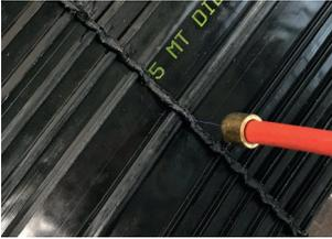
Mit Hilfe eines Funkenprüfgerätes können die Schweißverbindungen zerstörungsfrei auf ihre Dichtigkeit geprüft werden.
