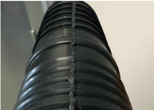
Die Festigkeit der Fügestelle kann durch starkes Biegen der abgekühlten Fügestelle geprüft werden. Es darf hiernach keine Schädigung der Fügenaht erkennbar sein.
