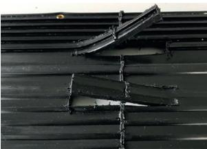
Mit der zerstörenden Messerschnittprüfung werden stichprobenartig Schweißverbindungen überprüft. Hierzu wird ein Schnitt entlang der halben Schweißnaht sowie ein Schnitt senkrecht zur Schweißnaht gesetzt. An diesen Schnittflächen erfolgt eine optische Begutachtung nach obigen Merkmalen.
