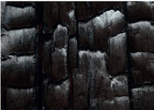
Dieses Merkmal zeigt sich bei zu hoher Temperatur und kann sich bei ungleichmäßiger Temperaturverteilung am Schweißelement auch nur in Teilbereichen der Schweißnaht zeigen.
