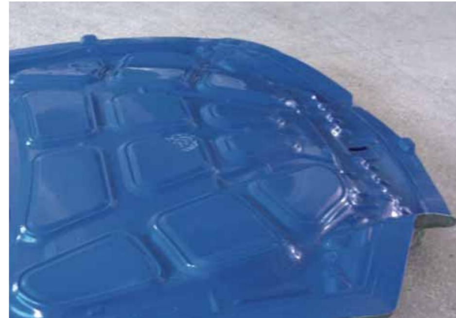
Werkzeug aus GC1 080 zur Herstellung von Verstärkungen für Motorhauben
