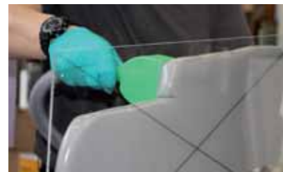
Die thixotrope Einstellung von SC 175 ermöglicht selbst einen vertikalen Auftrag von einzelnen Raupen ohne Absacken
