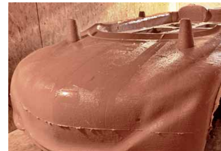
Große Modelle im Maßstab 1:1 können mit Biresin® M67 in einem Schritt vergossen werden
