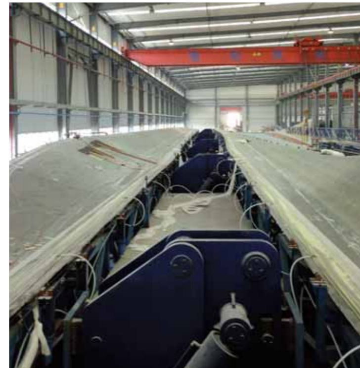
Vakuuminfusion eines Rotorblattes mit Biresin® CR131
