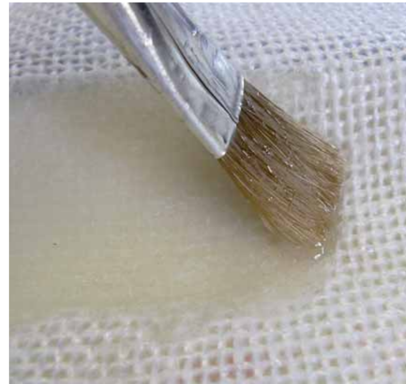
Herstellung von hochqualitativen Laminats mit ausgezeichneter Festigkeit
