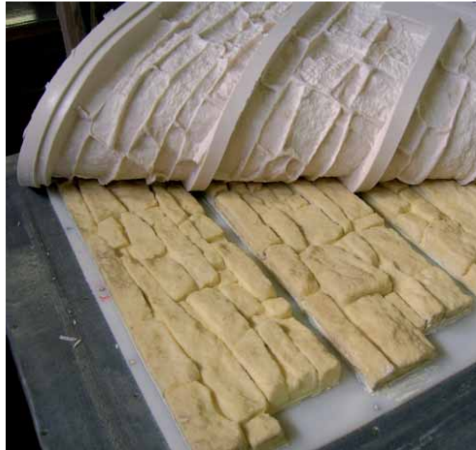
Entformung einer flexiblen Form für eine Verkleidung in Steinoptik hergestellt mit UR 58480
