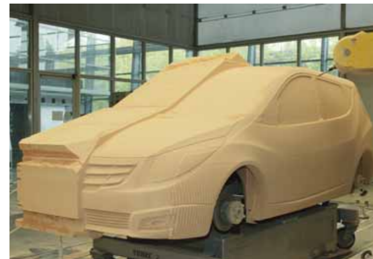
Designmodell im Maßstab 1:1 aus SikaBlock® M330, verklebt mit Biresin® Kleber orange
