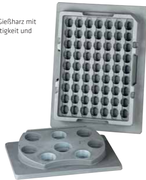
Tiefziehwerkzeug für Blisterverpackung hergestellt mit Biresin® G38
