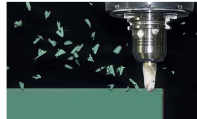
SikaBlock® M945 bietet exzellente Fräsbarkeit bei geringer Staubbildung
