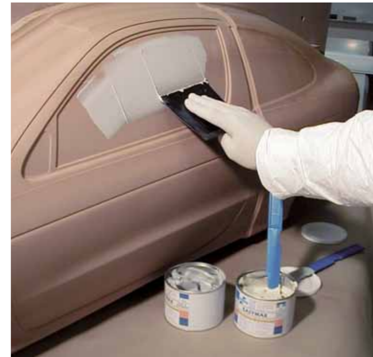
Easymax ist geruchlos und bietet eine schnelle Abbindezeit. Das Produkt eignet sich besonders als Reparaturspachtel für PUR-Platten mittlerer Dichte
