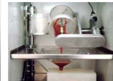
Das Vakuumgießverfahren ermöglicht die Herstellung von Teilen mit einem ausgezeichneten optischen Aspekt sowie besten mechanischen Eigenschaften
