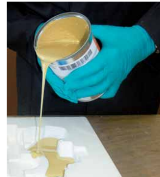
F160 mit Füllstoffzugabe für den Verguss von Modellen mit höherer Schichtstärke
