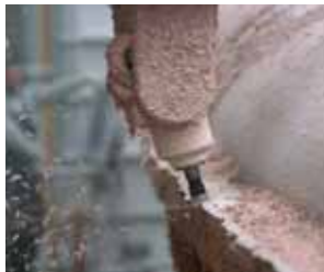
Biresin® M72 lässt sich sehr einfach und staubarm fräsen
