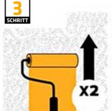
Eine zweite Schicht auf saugfähigen Untergründen auftragen.
