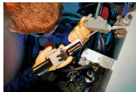
»1 Anbringen eines Schalters an ein Maschinengehäuse mit einem 2K-ADP-Klebstoff
