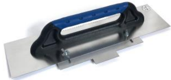
FloorJoint Verlegespachtel: Einstellbare Traufel zur ebenen Klebverteilung, Höhenjustierung und Fugenfreistellung.
