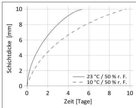
Diagramm 1: Durchhärtengeschwindigkeit Sikaflex®-298 FC
