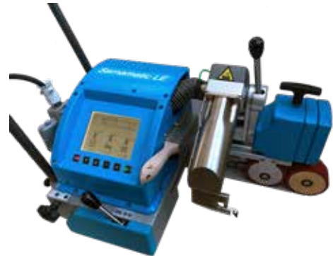
3 Sarnamatic® LE ■ Schnell durch voreingestellte Schweißparameter ■ Flexibel durch das enthaltene Umrüstset
