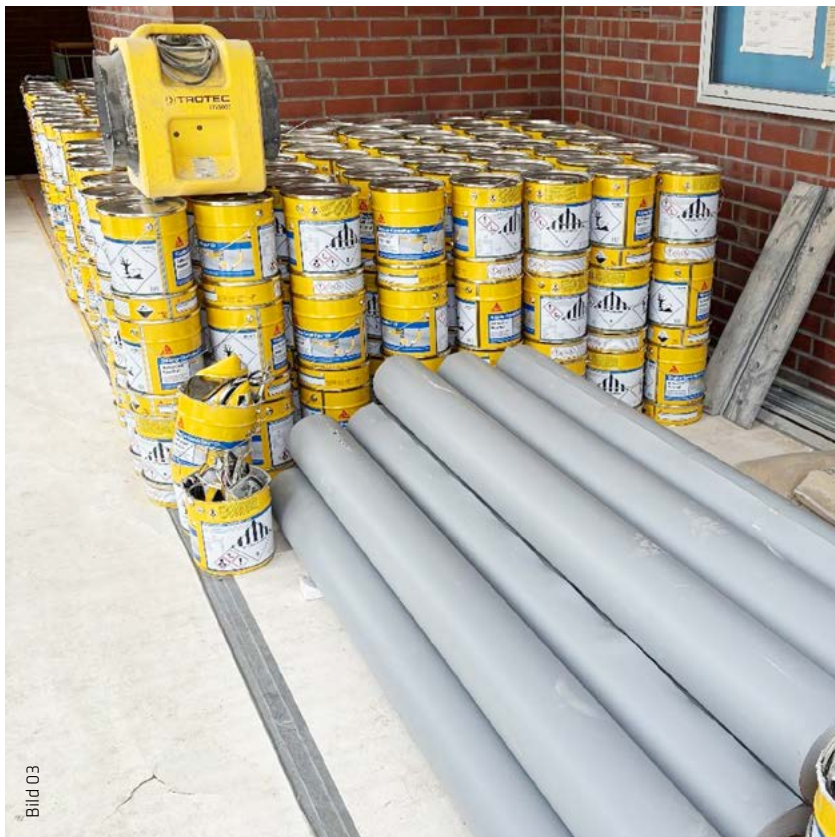
Sikadur-Combiflex® TF System, bestehend aus Systemkleber, Dichtstreifen und optional Fugenbandprofilen.
