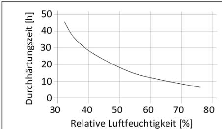
Diagramm 1: Durchhärtingszeit für einen 500 µm Klebstofffilm
