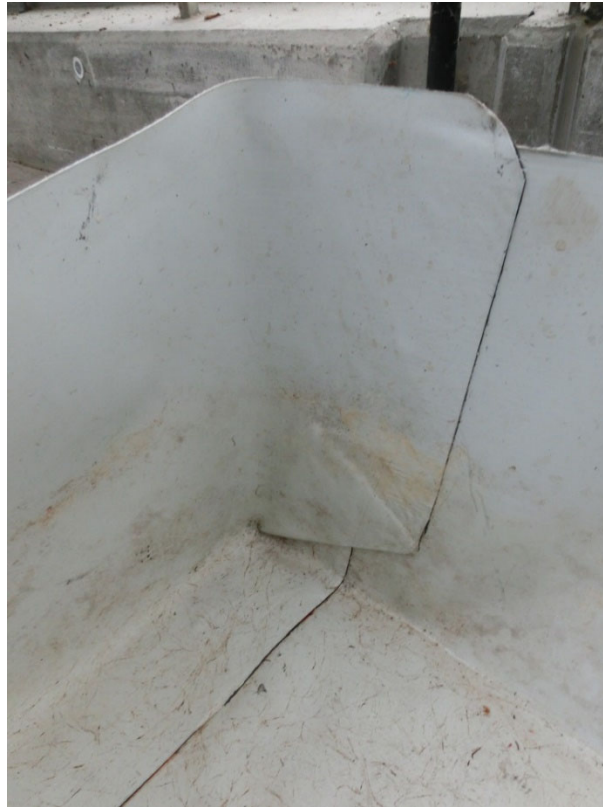
Abb. 3: Eckdetail des Prüfkörpers am Testende
