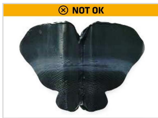
BILD 12 Folie auffalten - Negativer Test = unzureichende Mischung
