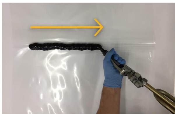
BILD 9 Klebstoffraupe in Richtung des Falzes auftragen
