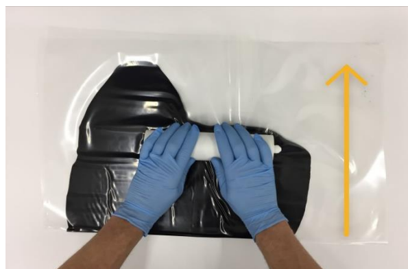
BILD 10 Die Klebstoffraupe nur rechtwinklig zum Falz beaufschlagen
