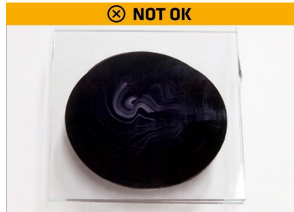
BILD 8 Negativer Test = unzureichende Mischung
