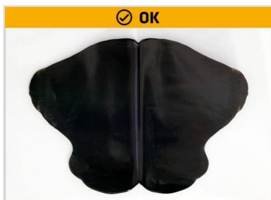
BILD 11 Folie auffalten - Positiver Test = ideale Mischung
