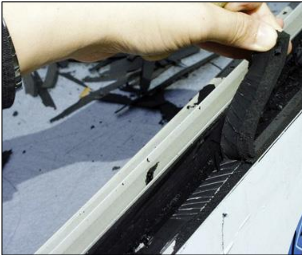
BILD 26 Gute Haftung (Adhäsion), Entglasungstest erfolgreich
