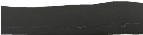
BILD 15 Weiße Streifen im Material, inhomogene Mischung
