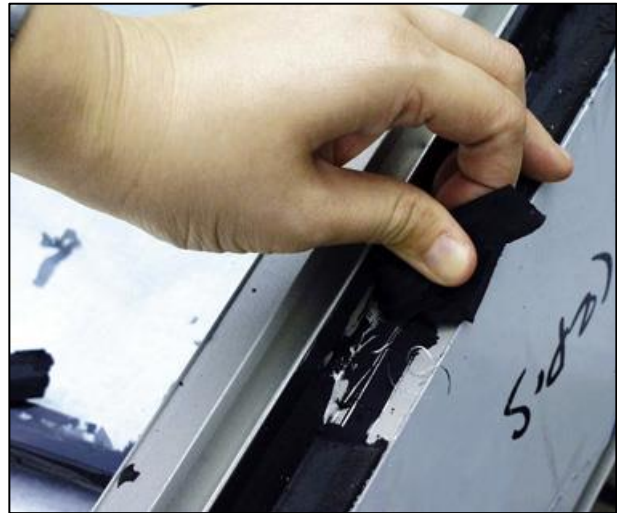
BILD 27 Klebstoffversagen, Entglasungstest nicht in Ordnung
