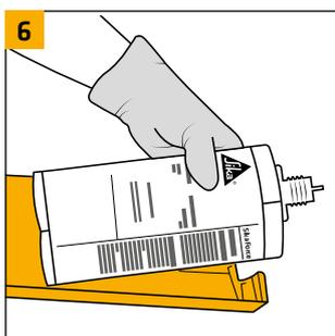
6 Die Kartusche in die Verarbeitungspistole einsetzen und sicherstellen, dass die Kartusche richtig eingerastet und ausgerichtet ist.
