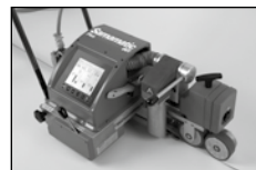
Sarnamatic® 681 Schweißautomat für Sikaplan® Bahnen 230 V / 400 V
