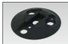
Sika® LVP-Universal Wird als Abschluss eines Sarnabarprofils bzw. von Punktbefestigungsreihen in den Eck- und Randbereichszonen zur Lastverteilung verwendet Durchmesser: 120 mm
