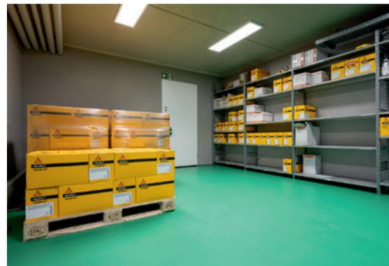
Der Boden im Lagerraum des Bürogebäudes erhielt die 2-komponentige Beschichtung Sikafloor®-3240 in RAL 6030 (Grün), der Farbe, die sich auch im Logo der Münsterland Fugen GmbH wiederfindet.
