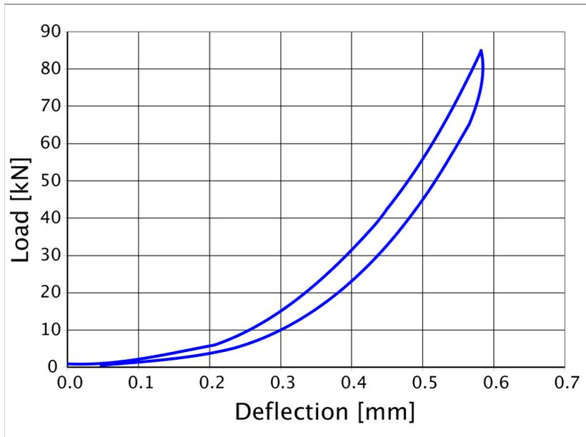
Statische Steifigkeit bestimmt in Anlehnung an DIN 45673-1.
