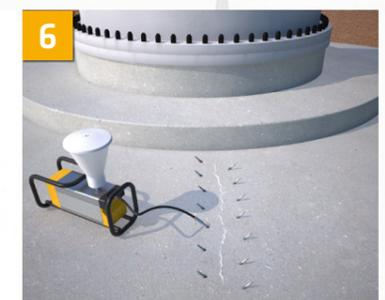
6 Die Verarbeitung erfolgt über Injektionspumpen.
