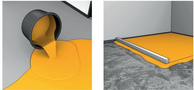
**SikaEmaco® T 800 DUO IST EINE INNOVATIVE 2-IN-1-LÖSUNG:** „DUO“ steht für die Einsetzbarkeit in zwei Einstellungen. Die Konsistenz ist variabel einstellbar: Je je nach Wasserzugabe entweder in erdfechter/standfester oder in verlaufender/ fließfähiger Konsistenz verarbeitet werden.
