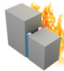
V4. Eine Seite: Sika® Backer Rod Fire Gegenüberliegende Seite: geschlossenzellige PE Rundschnur, z.B. Sika® Rundschnur PE
