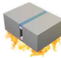
H4. Eine Seite: Sika® Backer Rod Fire Gegenüberliegende Seite: geschlossenzellige PE Rundschnur, z.B. Sika® Rundschnur PE
