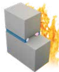
T4. Eine Seite: Sika® Backer Rod Fire Gegenüberliegende Seite: geschlossenzellige PE Rundschnur, z.B. Sika® Rundschnur PE
