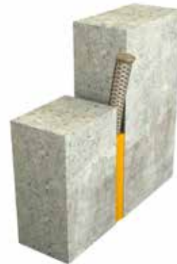
Bild 4: Brandbeständige Hinterfüllschnur mit herkömmlichem Fugendichtstoff
