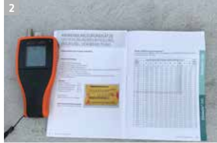
2 Ermittlung der Messwerte für Haftzug, Restfeuchte, Oberflächentemperatur und Taupunktsituation
