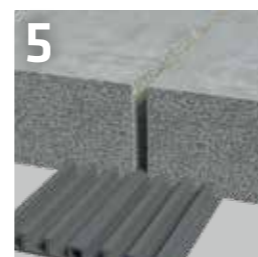
5 Dehnfugen unter Bodenplatten
