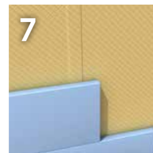
7 Anfüllschutz oder Perimeterdämmung
