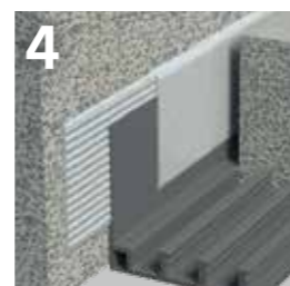
4 Anschlussfugen an Bestandsbauteile
