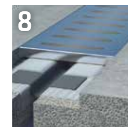
8 Überfahrbare Fugen- konstruktionen
