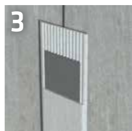
3 Fugen bei Fertig- teilelementen
