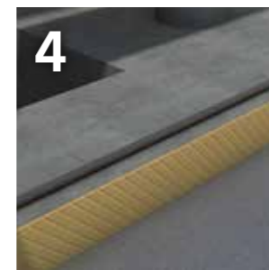
4 Arbeitsfugenabdichtung, z.B. Sika® Fugenblech-FBV oder KAB-Fugenband
