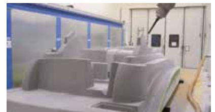
CNC-Bearbeitung eines Bootsdecks, hergestellt aus der extrudierbaren Paste SC 175
