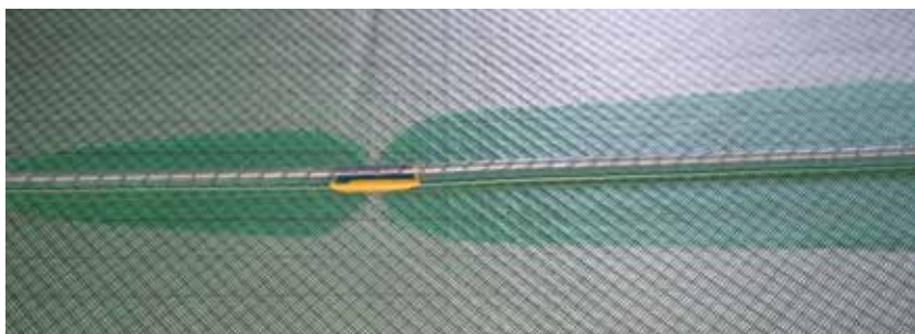
Vacuuminfusion eines Rotorblattes mit Biresin® CR131.
