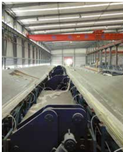
Vacuuminfusion eines Rotorblattes mit Biresin® CR131.
