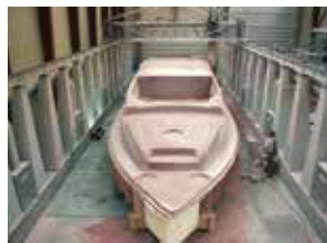
CNC-bearbeitetes Modell eines Bootsdecks mit einer gleichmäßigen fugenfreien und glatten Oberfläche
